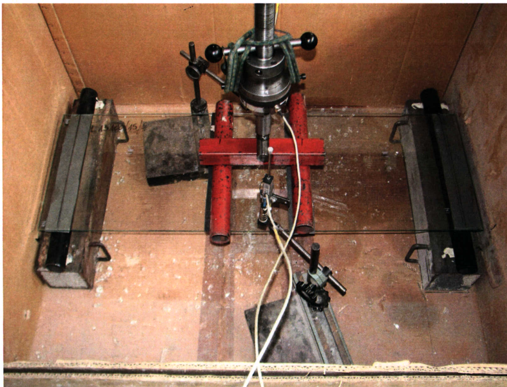
Slika 1: Način preskušanja upogibne trdnosti vzorcev stekla (foto arhiv ZAG št: 26963d-05)
